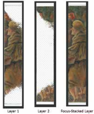
図32: 上画像は、焦点結合を説明するために選んだ第二の例である。作品がほぼフラットであったため、この場合は、2層のレイヤーを使用した。今回の主な原因は、カンヴァスのたるみである。今回の撮影では、水平な形での撮影を行ったため、特に大きな絵画の場合には、カンヴァスの重量により絵の中央付近でボウル状にたるみがちだ。カンヴァスの張りが充分なされている場合、この現象は最小限に抑えられる。ただ、古い作品の場合はより起こりやすいため、焦点結合が必要になってくる。
