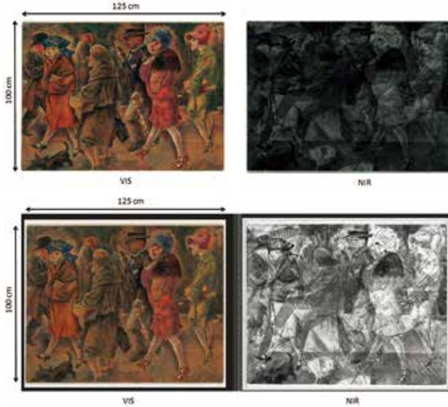
図12: 可視光と近赤外光を並べて比較した。前述のように、これらの画像は同時に撮影された。右のものは近赤外画像で、左側のは可視光画像。近赤外画像には2つのバージョンがあり、上部の画像は後処理としてシェーディング補正した元の画像、下部の画像は、検出された特徴を簡単に参照できるように明るさとコントラストを増加させたもの。
