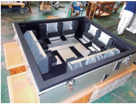
汎用クレート内部の構造
