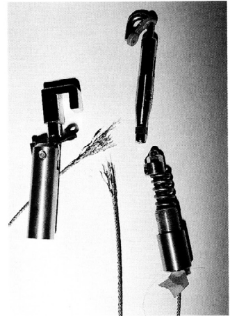
fig.3 表4-番号10で使用したハンガー、フック、ケース、パネ、および切断されたワイヤー
